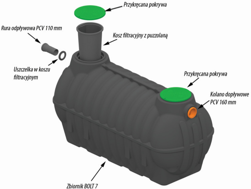
Rys. 5. Osadnik gnilny BOLT 3,5 oraz elementy składowe
